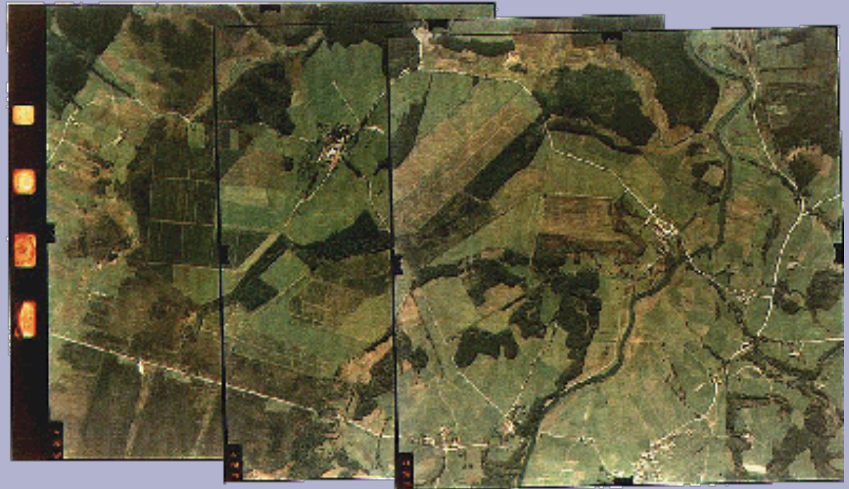
Sterocoppie acquisite da aereo per rilievo IGM 25000
